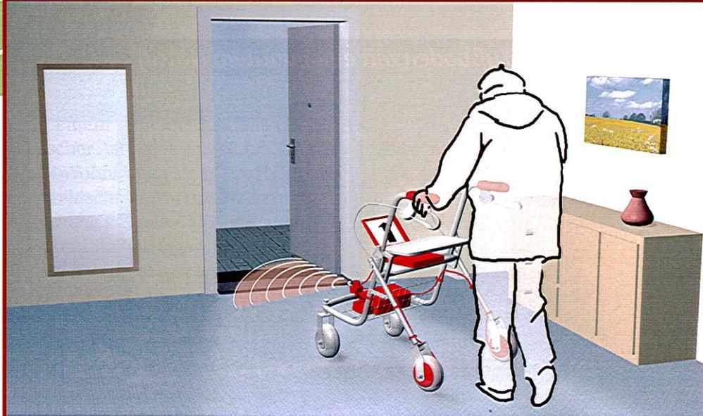
„Wo geht's zum Ausgang?“ Der Rollator, den Wissenschaftler des Deutschen Forschungszentrums für Künstliche Intelligenz in Bremen entwickeln, zeigt es durch einen Pfeil auf dem Bildschirm. Ein Hindernismelder spürt Stolperfallen auf und bremst gegebenenfalls die Hinterräder ab. Das Wunschziel, das sowohl in als auch außerhalb der Wohnung liegen kann, lässt sich auf dem Monitor durch Hin-und-her-Rollen der Gehhilfe wählen.
